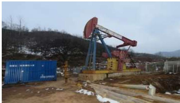
中联煤CO<sub>2</sub>-ECBM试验注入泵及矿场照片
